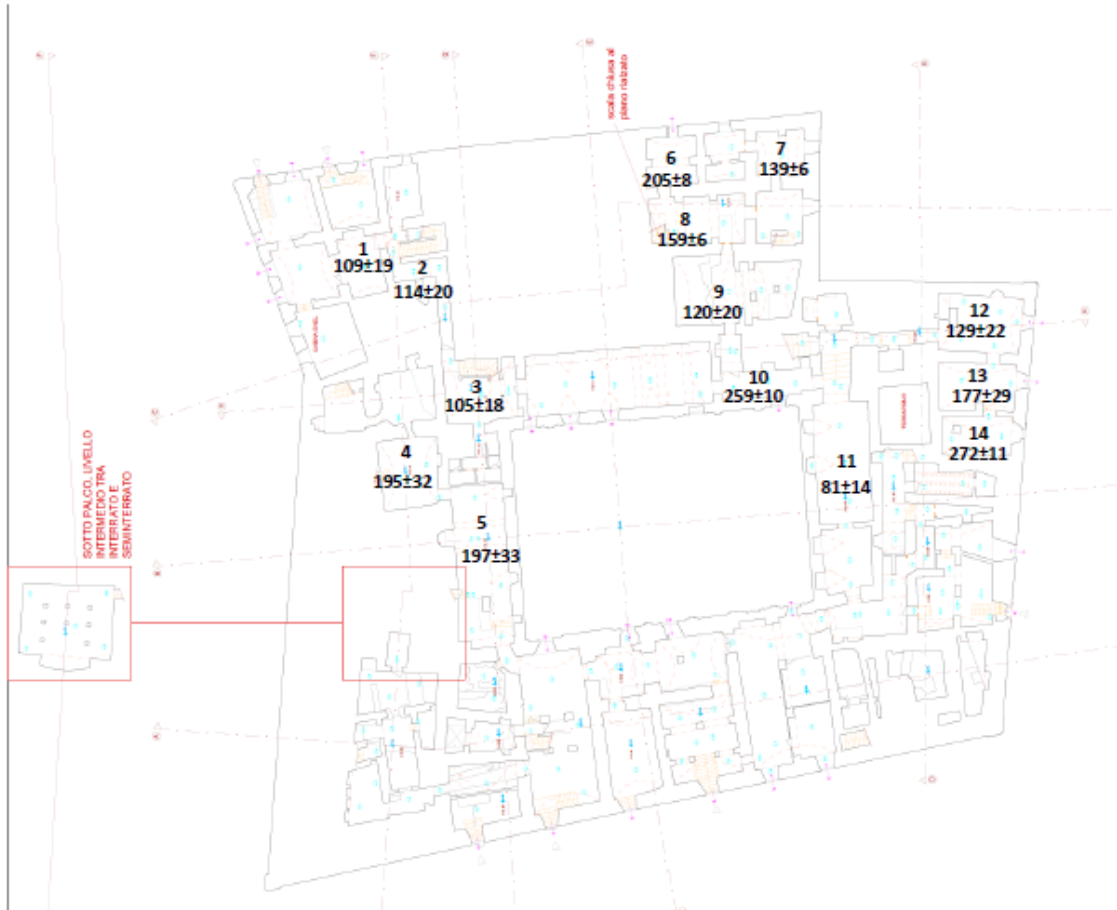
Figura 1. Indicazione dei punti di misura del radon al piano interrato di Palazzo Altemps (Roma)
